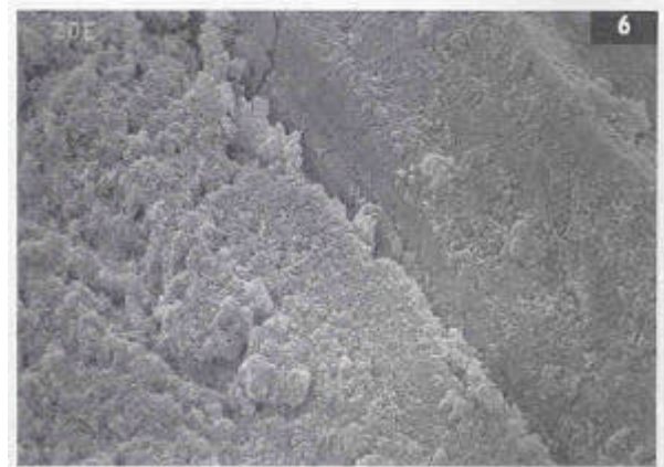
Fig.6 Gap tra amalgama e parete dentinale (Sem 1000x)
