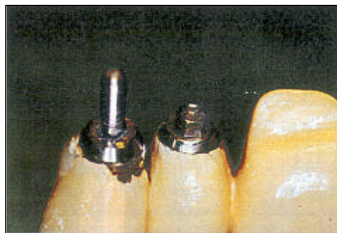
4. Insufficiente precisione dell'esagono di incastro, stelo disponibile a deformazione insufficiente, carichi non bene valutati, diametri sottodimensionati hanno provocato: parziale svitamento di una vite, frattura dell'altra vite dentro l'impianto, frattura dell'esagono di incastro della vite svitata:
