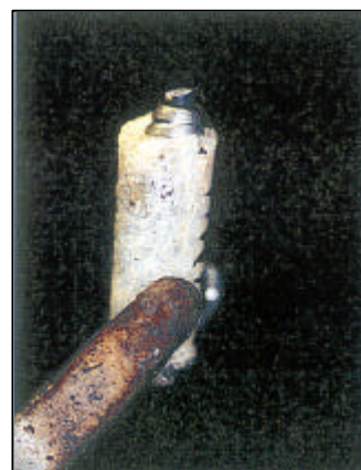
8. Incastro conico con moncone fratturato
