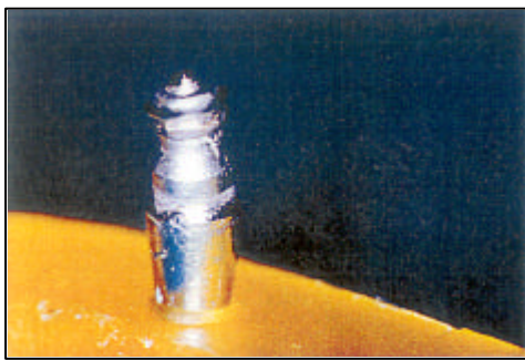
1. Impianto, con connessione a vite, fratturato dopo un periodo di allentamento della vite del moncone
