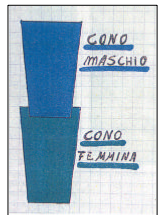
7. Il principio del cono Morse si basa sull'incastro che si crea tra i due coni opportunamente preparati
